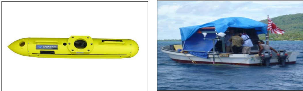
インターフェロメトリ方式音響測深機 C3D と調査船
